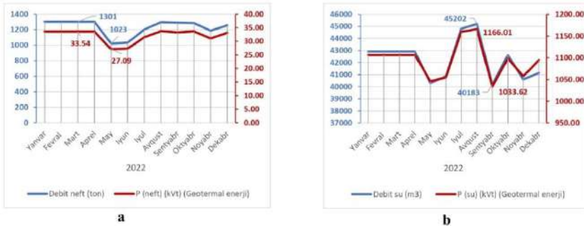
Şəkil 10. 2022-ci il aylar üzrə flüidın (a – neft, b – su) daşıdığı geotermal enerjinin gücünün dəyişməsi (Tərtib edən P.Y.Məmmədov)
