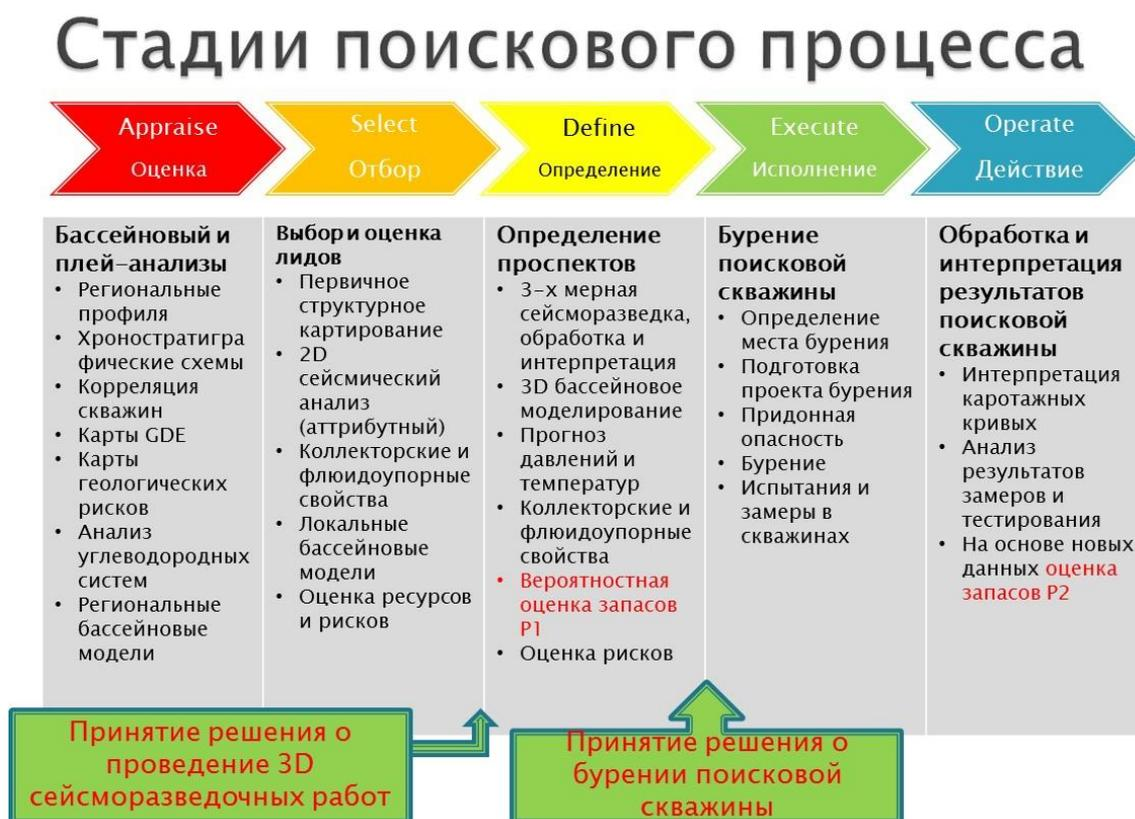
**Рис. 2.3.2.** Цели и задачи, решаемые на различных стадиях поисковых работ
