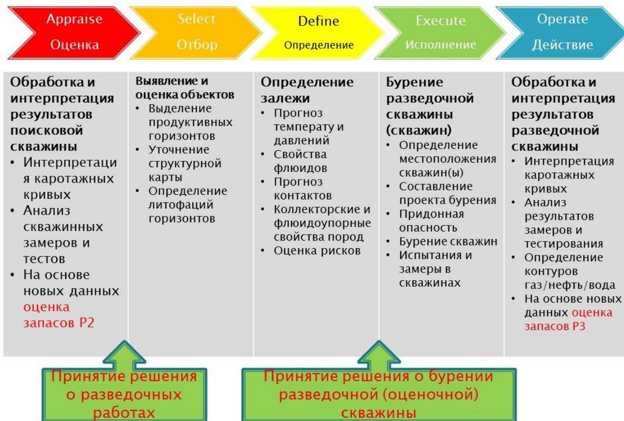
**Рис. 2.3.3.** Цели и задачи, решаемые на различных стадиях разведочных (оценочных) работ
